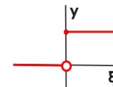
$$f(\xi) = \begin{cases} 1 & \text{pro } \xi > 0 \quad \dots \text{neuron je aktivní} \\ 0.5 & \text{pro } \xi = 0 \quad \dots \text{neuron je tichý} \\ 0 & \text{pro } \xi < 0 \quad \dots \text{neuron je pasivní} \end{cases}$$
